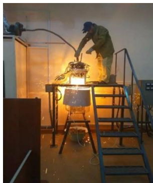
Рисунок 6 – Момент сливания расплава и его преобразования в волокно
