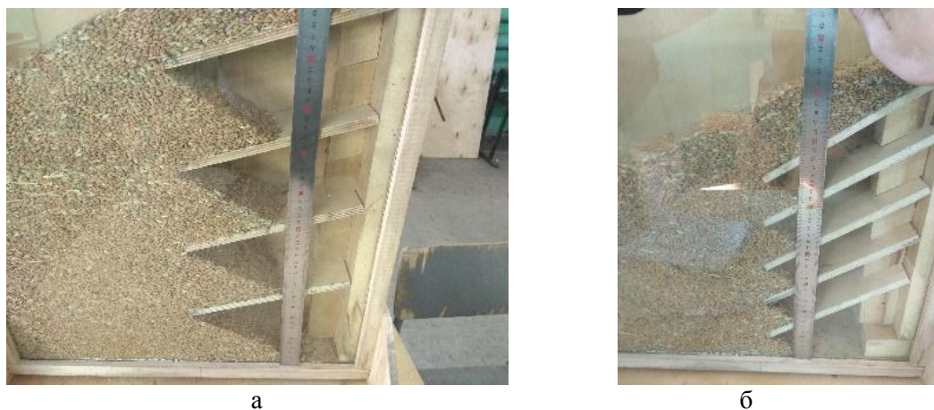
Рисунок 3 – Размещение перегородок в зерновой насыпи в разработанной установке: а – под наклоном с большим расстоянием между ними; б – под наклоном при уменьшенном расстоянии между перегородками
