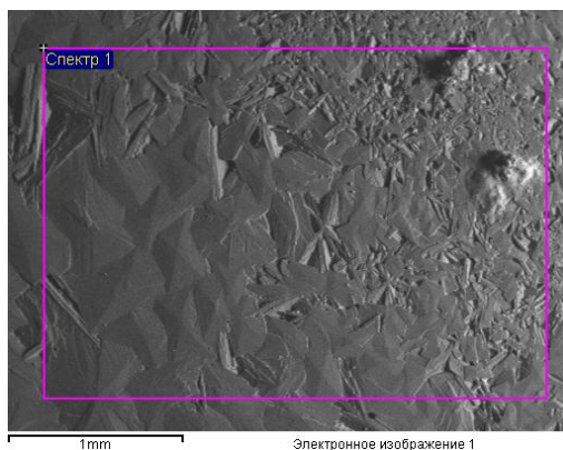
Рисунок 8 – Микрофотографии каменного литья с массовым содержанием компонентов 70:30 (хвосты бороизвлечения – стеклобой), 40×
