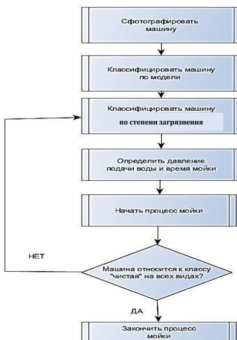
Рисунок 9 – Блок-схема алгоритма управления мойкой
