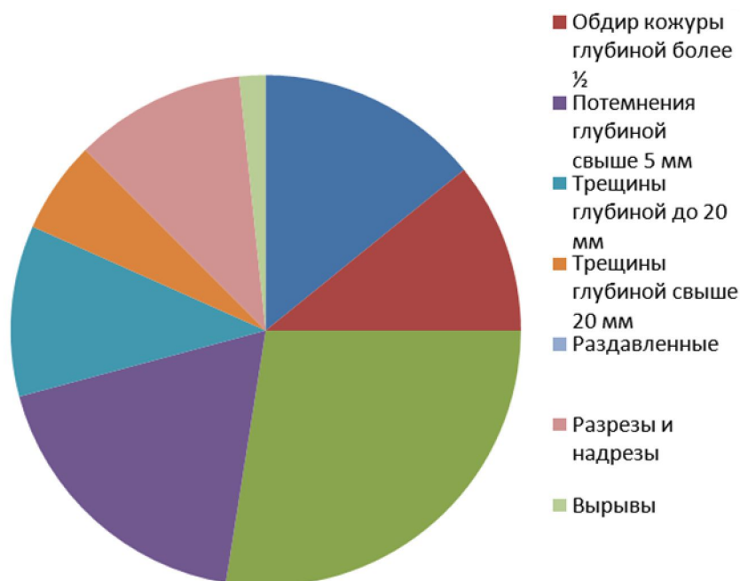
Рис. 8. Структура повреждений клубней картофеля при уборке комбайном SE-75-30
